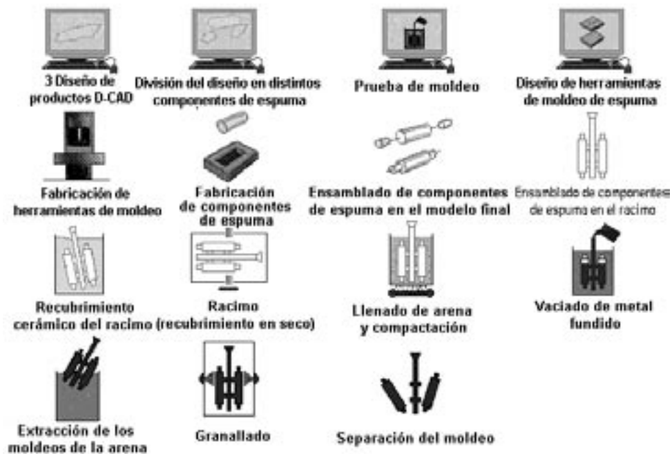
Figura 2.36. Proceso a la espuma perdida [110, Vito, 2001]
