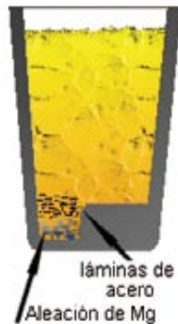
Figura 2.23. Nodulización siguiendo el método «sandwich» [237, HUT, 2003]
