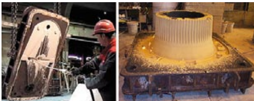
Figura 2.34. Recubrimiento por flujo con base de alcohol, seguido del encendido o secado [237, HUT, 2003]
