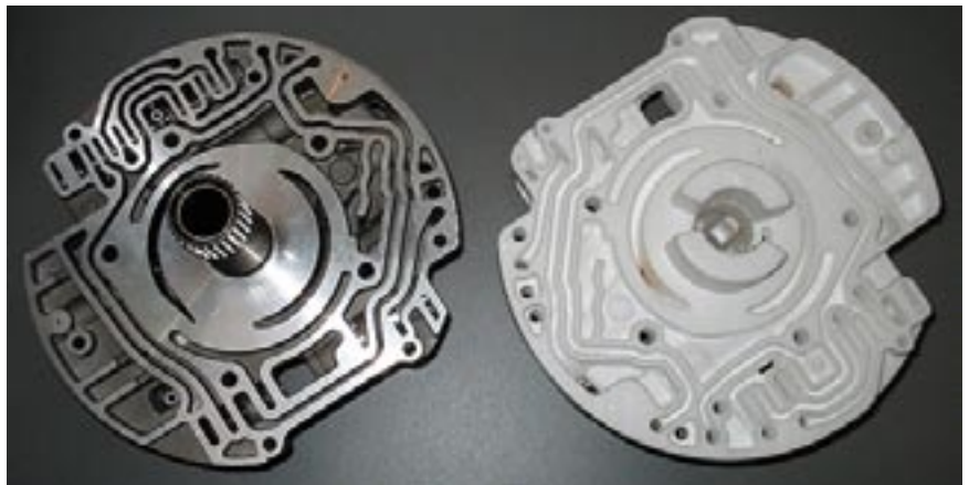
Figura 2.37. Modelo de poliestireno desechable (der.) utilizado en el proceso a la espuma perdida y ejemplo de moldeo producido siguiendo este método (izq.) [237, HUT, 2003]
