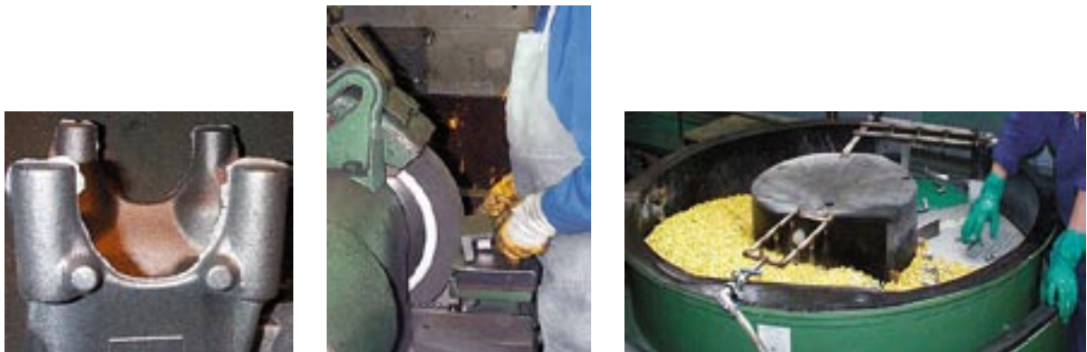
Figura 2.51. Rebabas (izq.) y su extracción mediante una piedra de amolar (centro) y una muela corredera (der.) [237, HUT, 2003]
