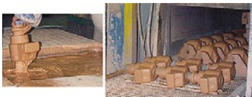
Figura 2.34. Recubrimiento por flujo con base de alcohol, seguido del encendido o secado [237, HUT, 2003]
