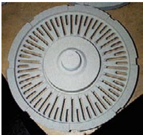
Figura 2.32. Macho confeccionado en caja fría [237, HUT, 2003]
